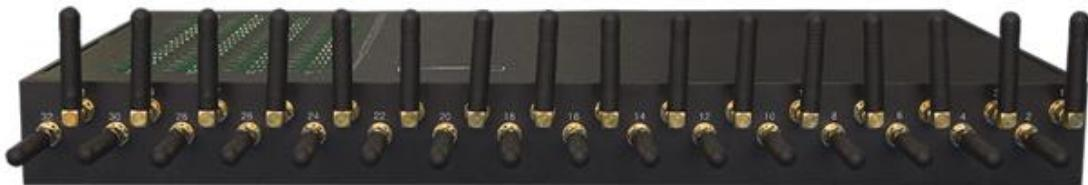
**注意：2G 网关和 4G 网关两种类型的天线不能混用。4G 网关的天线上标有“4G”字样。**
